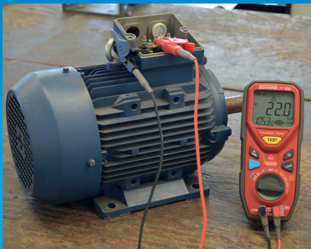
Messung des Isolationswiderstandes mit 1000 V
