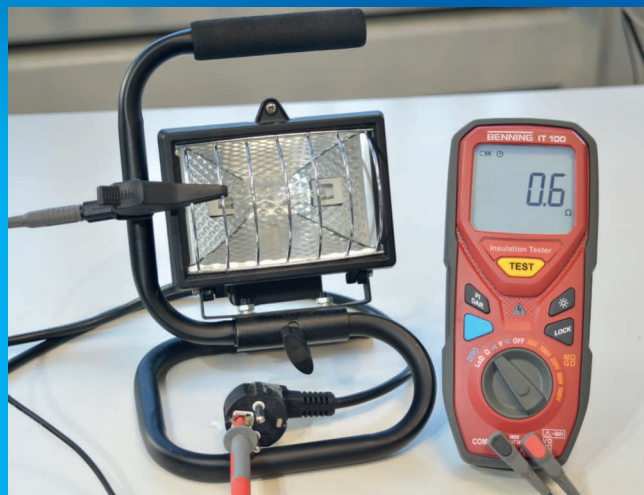
Widerstandsmessung zur Prüfung des Schutzleiters
