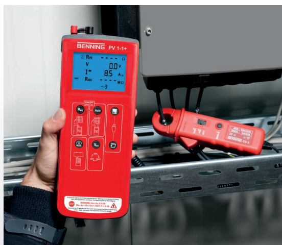
DC-Betriebsstrommessung mit BENNING CC 3
